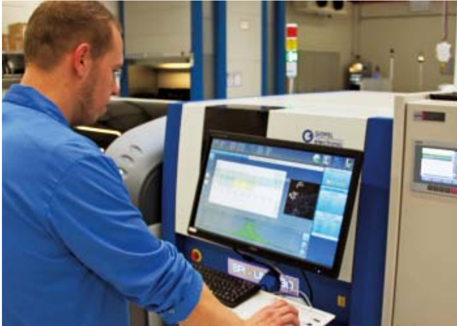
Darstellung der Prozesslage am SPI-Line 3D
