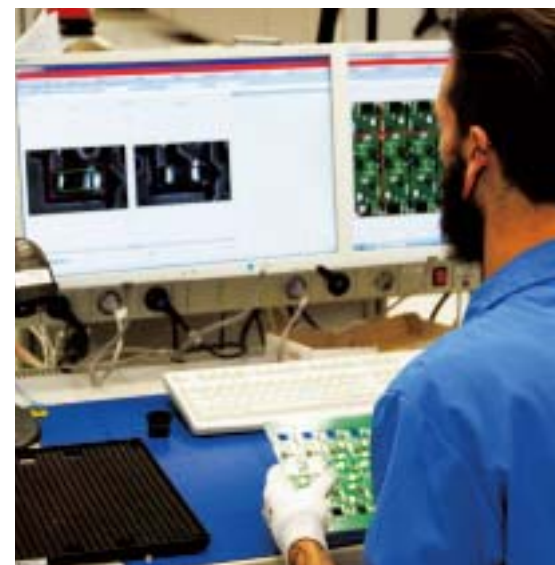
Auswertung der optischen Inspektion am Reparaturplatz
