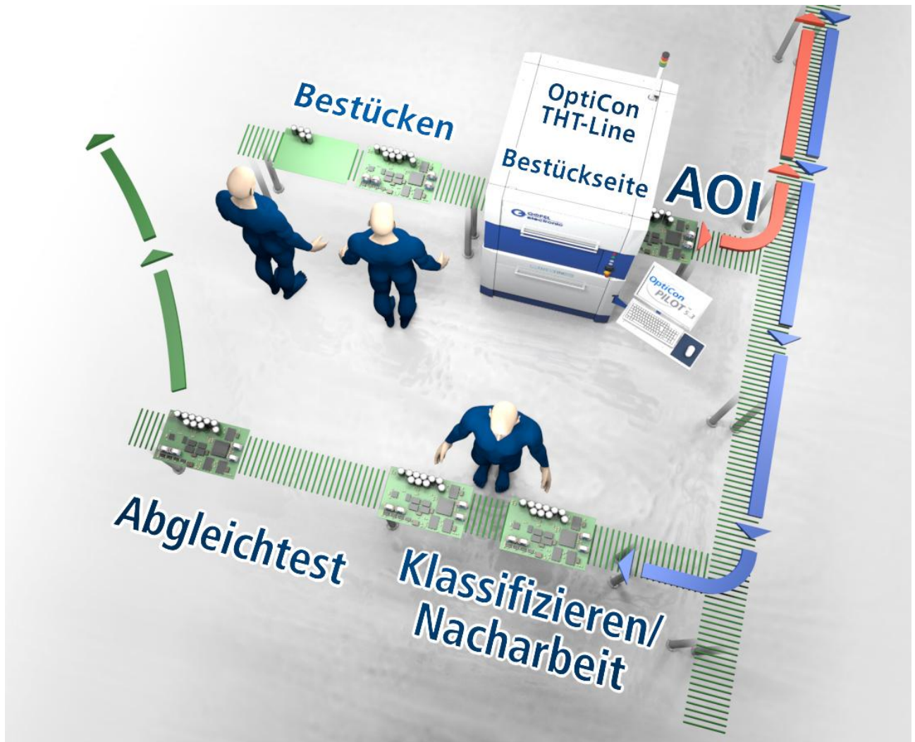
Bild 3: Schema Bestück- und Nacharbeitsplatz
