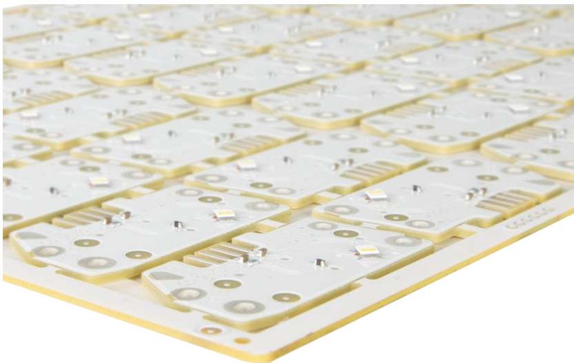
Abb. 1: LED-Platine als Mehrfachnutzen für Seitenblinker vom Fahrzeug
